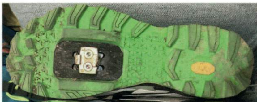
FIGURA 27 – RESULTADO DEL RESOLADO
