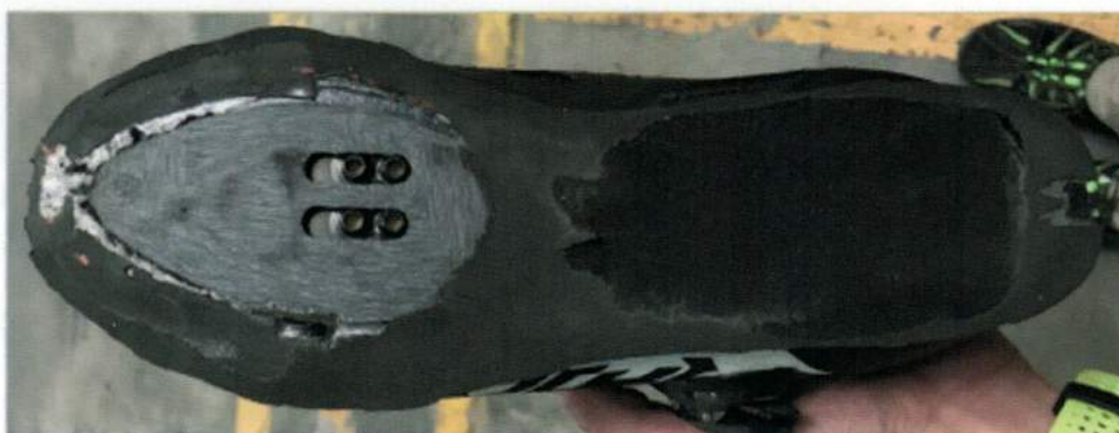
FIGURA 21 – CARDADO ÓPTIMO DEL FONDO CON GOMA, EVA Y LÁMINA DE PLÁSTICO
