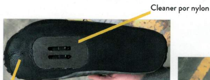
FIGURA 9 - CARDADO ÓPTIMO CON EVA A VISTA Primer por EVA
