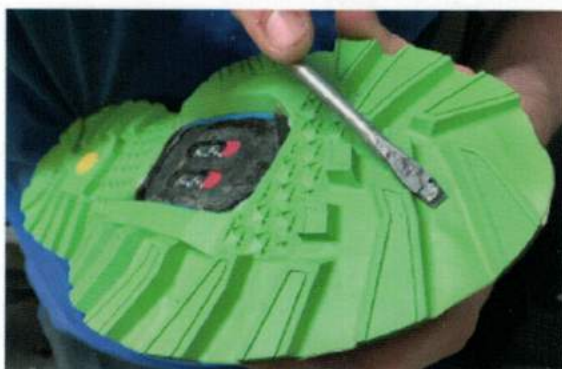
FIGURA 3 – PROCEDIMIENTO PARA ELIMINAR LAS POSIBLES BURBUJAS ATRAPADAS BAJO LA SUELA
