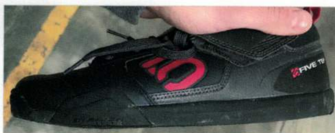
FIGURA 10 - CARDADO EXCESIVO EN EL TALÓN. EL PERFIL IDEAL DEBERÍA RESPETAR EN MAYOR MEDIDA LA INCLINACIÓN ORIGINAL DE LA ZAPATILLA
