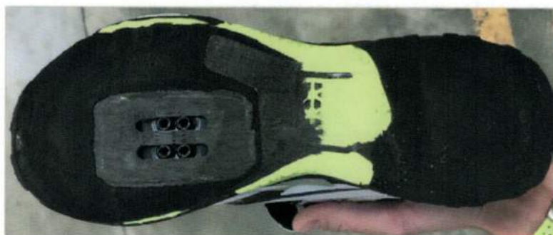
FIGURA 25 – PREPARACIÓN DEL FONDO DE LA ZAPATILLA CON GOMA, EVA Y LÁMINA
