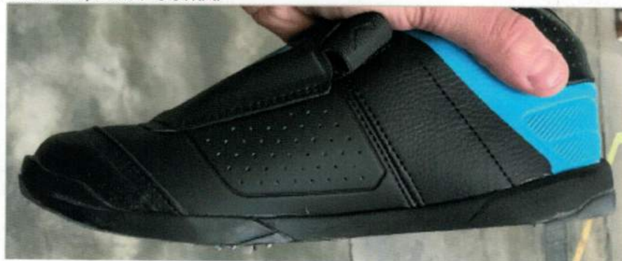
FIGURA 14 – CARDADO EXCESIVO DEL PERFIL LATERAL
