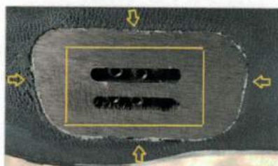
FIGURA 11 – CARDADO A RAS DE LA LÁMINA DE PLÁSTICO
