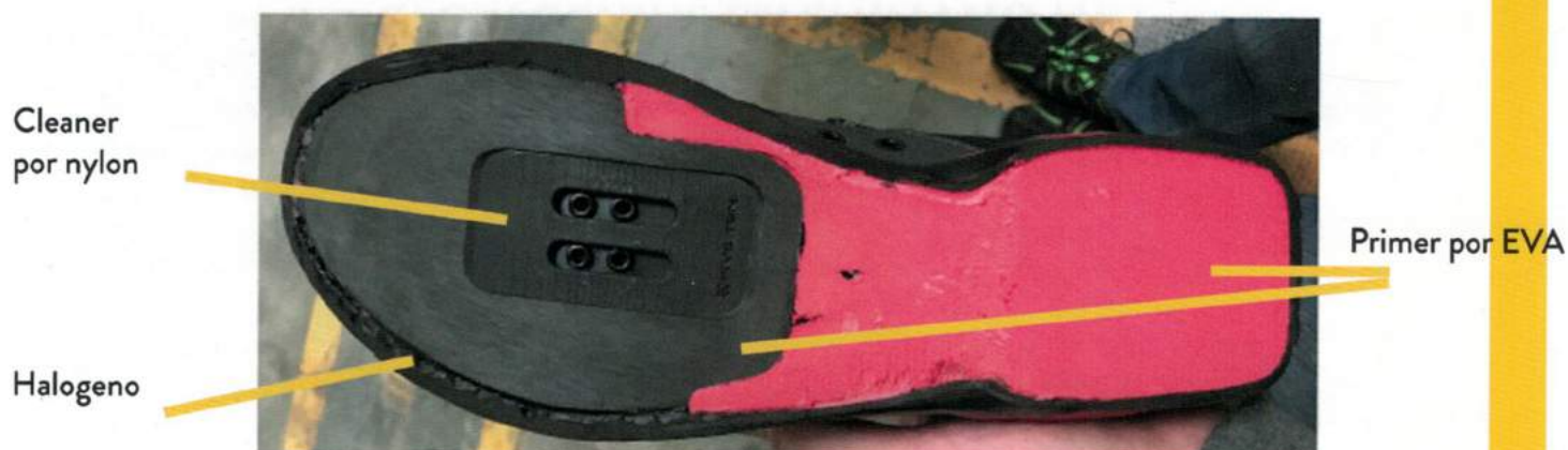
FIGURA 6 - PLANTA CON BORDE DE GOMA RESTANTE
